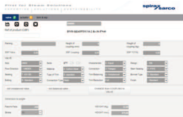
Écran des paramètres de configuration d'une vanne seule
